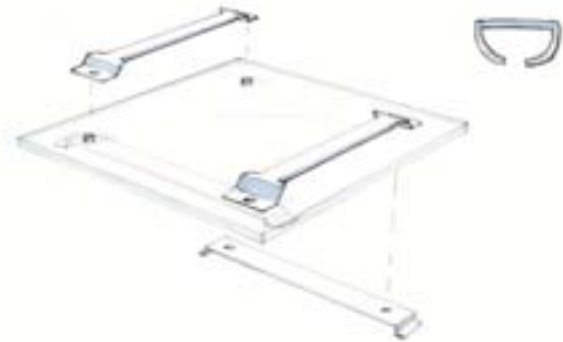
Paperikoneen huoltoluukku, helposti valmistettava yleismalli kaikkiin tilanteisiin.
